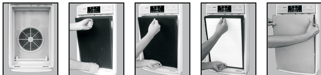
1. Åbn frontpanelet 2. Indsæt fotokatalysator- og fiberfilteret 3. Indsæt kulfilteret 4. Indsæt HEPA-filteret 5. Monter frontpanelet
