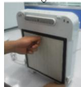
Aseta uudet suodattimet paikoilleen siten, että valkoinen nauha tulee ulospäin. Varmista, että esisuodatin osoittaa ilman sisääntuloon päin.
